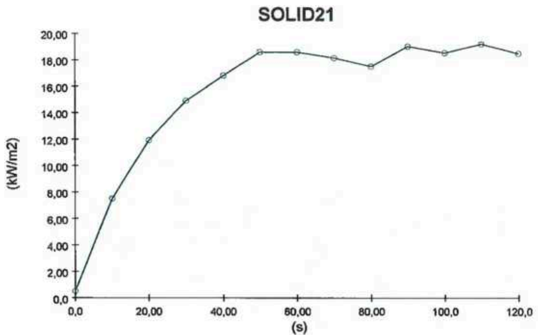
Рисунок 2.11 – Максимальное тепловое воздействие (падающий тепловой поток излучения) на область глухой конструкции павильона, сценарий №1
