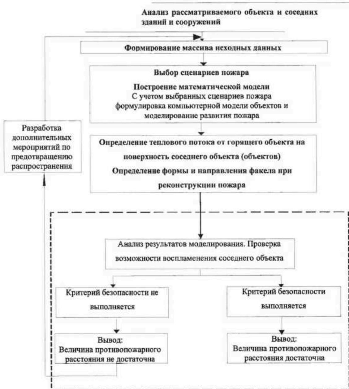
Рисунок 1 – Алгоритм численного эксперимента при ответе на вопрос о возможности распространении пожара между объектами
