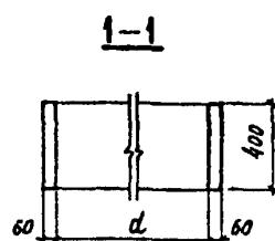
Стаканы для установки крышиных вентиляторов
