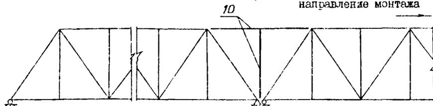
ПРОЛЕТНЫЕ СТРОЕНИЯ ДЛЯ ЖЕЛЕЗНОДОРОЖНЫХ МОСТОВ С ЕЗДОЙ ПОНИЗУ, ПРОЛЕТАМИ 33-110 м, МЕТАЛЛИЧЕСКИЕ, СО СВАРНЫМИ ЭЛЕМЕНТАМИ ЗАМКНУТОГО СЕЧЕНИЯ И МОНТАЖНЫМИ СОЕДИНЕНИЯМИ НА ВЫСОКОПРОЧНЫХ БОЛТАХ В ОБЫЧНОМ И СЕВЕРНОМ ИСПОЛНЕНИИ
