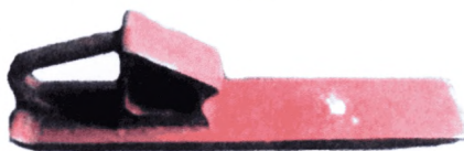
Рис.8.3. Искробезопасный латунный тормозной башмак БК-1.
