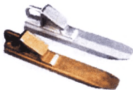
Рис.8.10. Неокрашенные тормозные башмаки.
