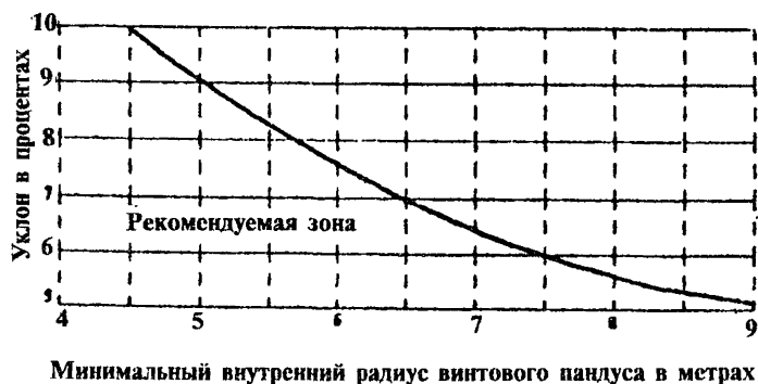
График 2. Зависимость внутреннего радиуса винтового пандуса от величины его уклона
