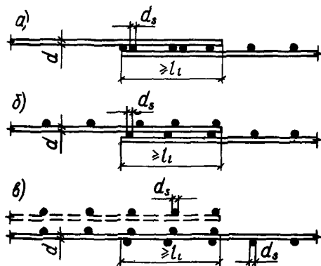
Черт. 107. Стыки сварных сеток внахлестку в направлении рабочей арматуры, выполненной из гладких стержней
