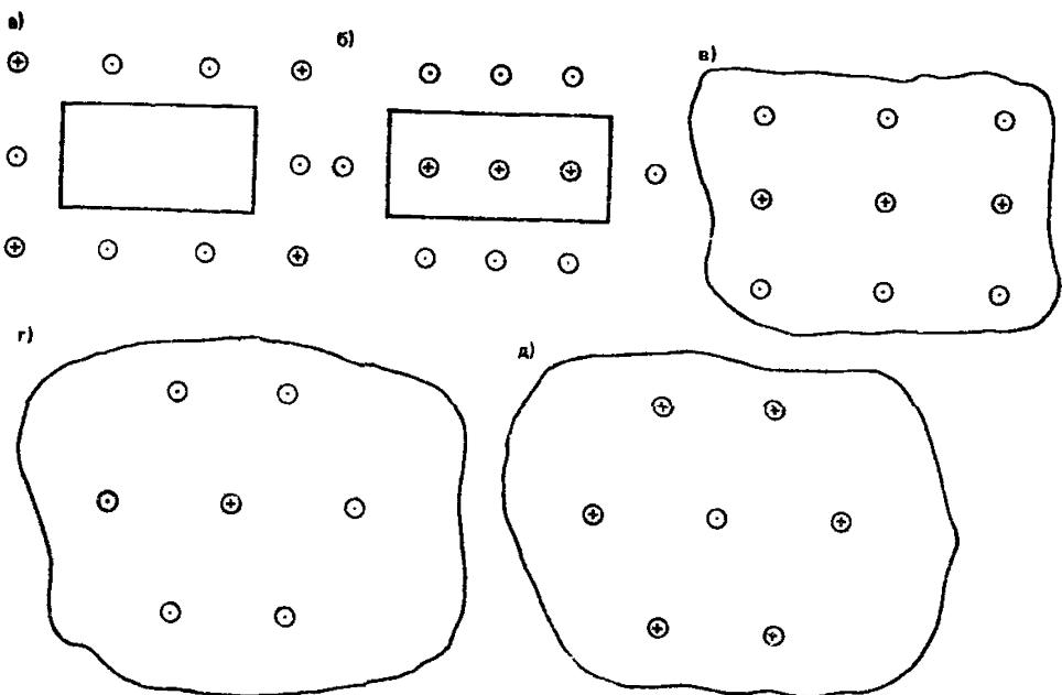
**Рис. 56. Схемы планового расположения скважин пневмоагнетательных дренажей**
