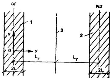
очаге приписывается знак «—», а если граница пласта непроницаемая — знак «+». При наличии двух параллельных границ пласта отображение производится относительно обоих границ с сохранением указанного выше правила знака. В этом случае количество отображенных полос оказывается бесконечно большим.
