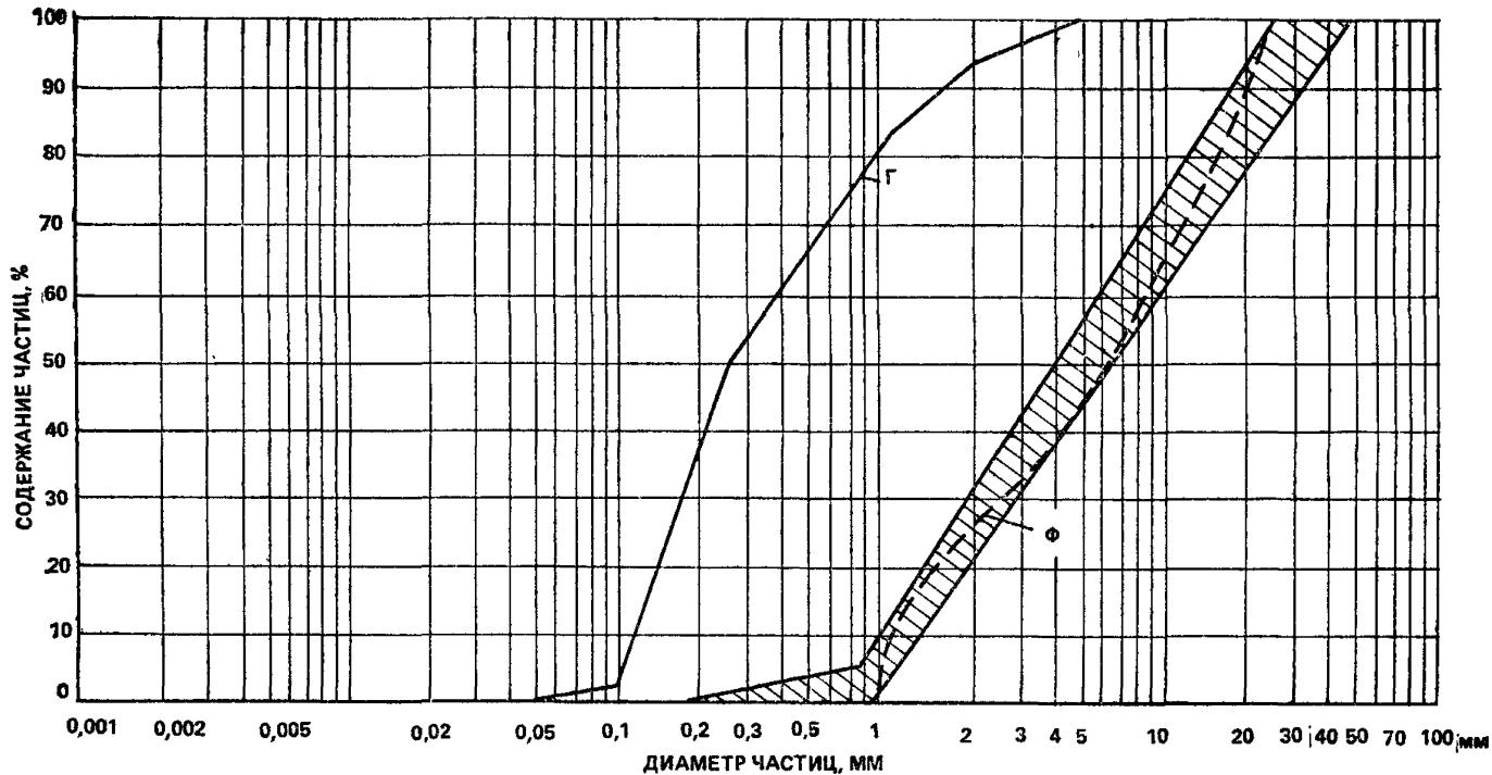
Рис. 135. Кривые гранулометрического состава к примеру подбора зернового состава фильтра для несвязанного несуффозионного грунта
