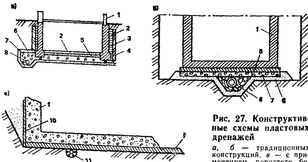
**Рис. 27. Конструктивные схемы пластовых дренажей**
