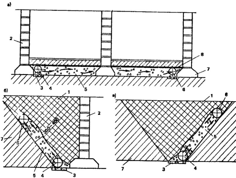
**Рис. 29. Типы вентиляционного дренажа**
