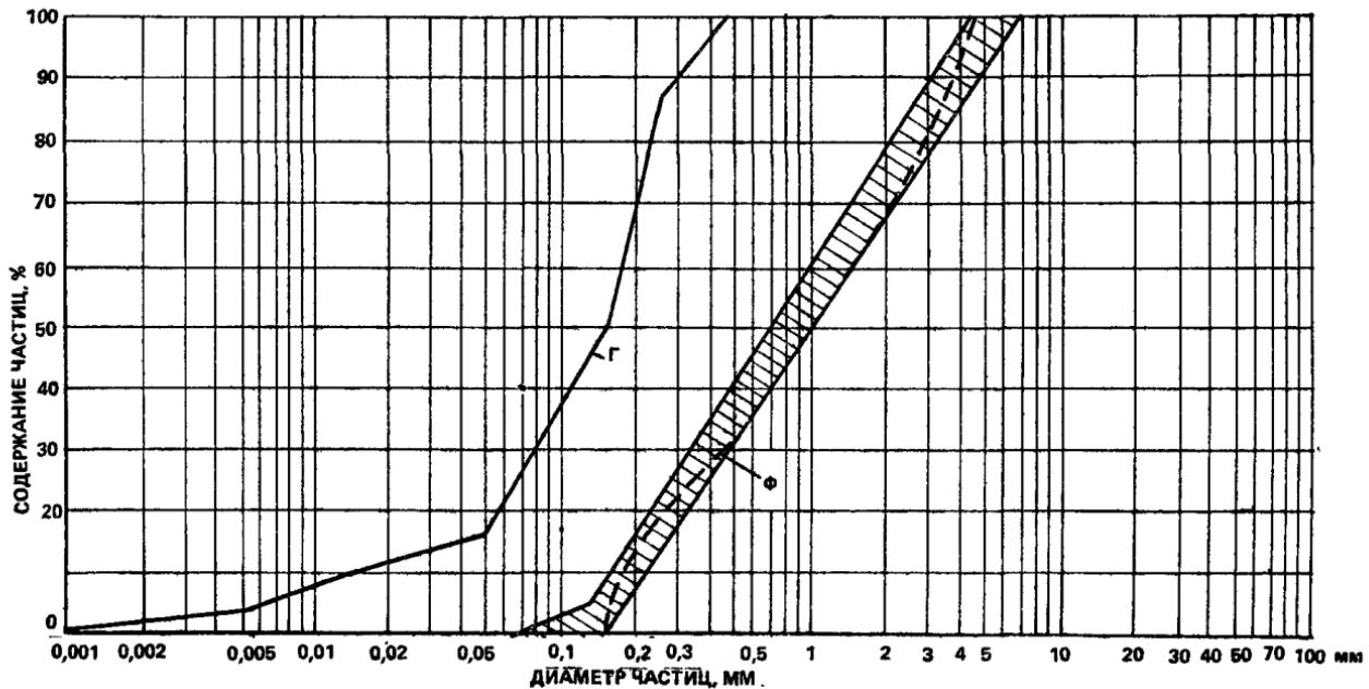
Рис. 136. Кривые гранулометрического состава к примеру подбора зернового состава фильтра для несвязного супфозионного грунта
