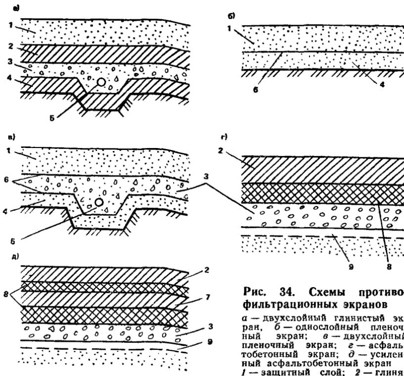
Рис. 34. Схемы противофильтрационных экранов
