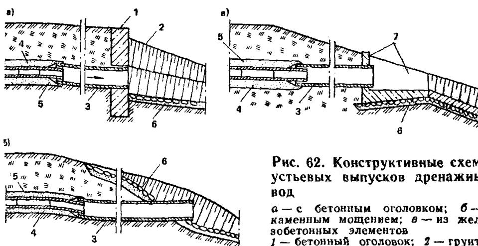
**Рис. 62. Конструктивные схемы устьевых выпусков дренажных вод**
