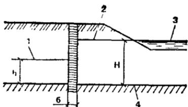
**Рис. 32. Схема противофильтрационной завесы**
