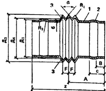
Рис. 40. Конструкция гибкой соединительной муфты
