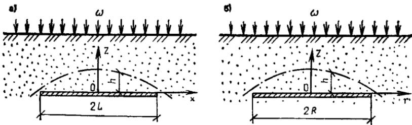
Рис. 1. Схемы к формированию техногенной верховодки в зоне аэрации на непроницаемых линзах удлиненной (а) и окружной (б) в плане формы.
