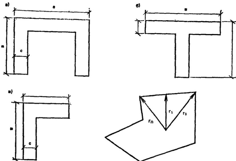
Рис. 76. Контурные дренажи различных в плане форм
