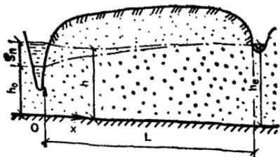
Рис. 21. Подпор грунтовых вод в междуречном массиве
