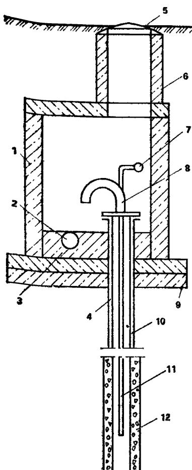
Рис. 51. Конструктивная схема дренажной скважины с эрлифтным отбором воды
