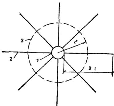
Рис. 96. Схемы (в плане) многолучевых дренажей с несимметричным расположением дрен-лучей
