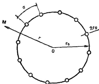
Рис. 115. Кольцевая система скважин в неограниченном пласте
