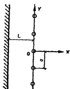
Рис. 114. Линейный ряд скважин в полуограниченном пласте
