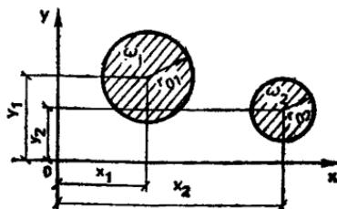
2.30. По методу суперпозиции осуществляется учет изменения интенсивности инфильтрации во времени, одновременное действие нескольких очагов инфильтрации. Наличие прямолинейных границ пласта учитывается методом зеркальных отображений.
