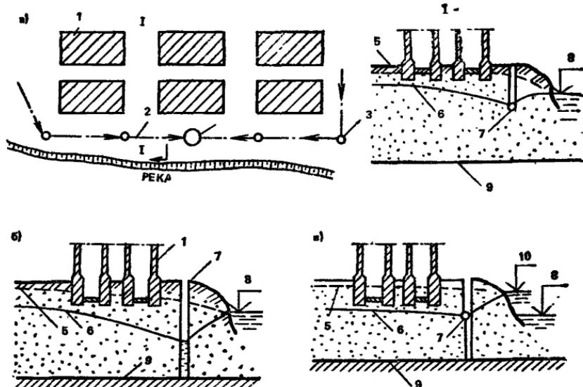
**Рис. 36. Схема берегового дренажа**
