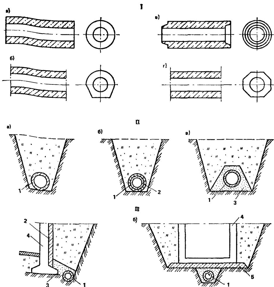
**Рис. 39. Конструкции дренажей с применением трубофильтров**
