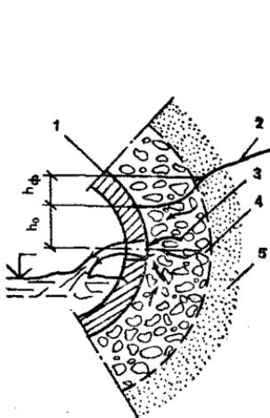
**Рис. 120. Схема истечения фильтрационного потока через круглое отверстие в стенке дренажной трубы**
