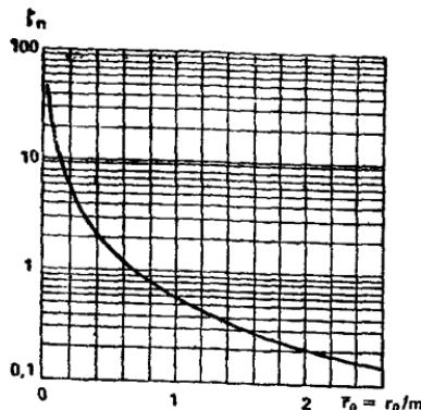
Рис. 91. Значения сопротивления пластового дренажа  $\zeta$  в однослоином пласте
