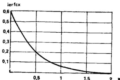
Рис. 11. График функции  $\text{ierfc } x$ .
