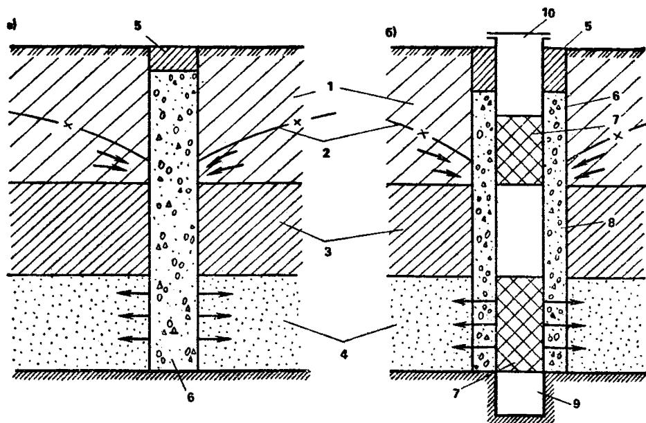
Рис. 47. Схемы конструкций вертикальных поглощающих дренажных скважин
