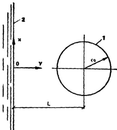
Рис. 84. Схема кольцевого дренажа вблизи прямолинейного контура питания
