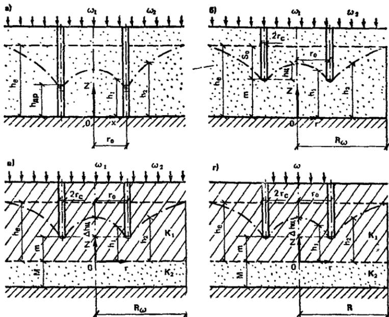
**Рис. 77. Схемы кольцевого несовершенного горизонтального дренажа**
