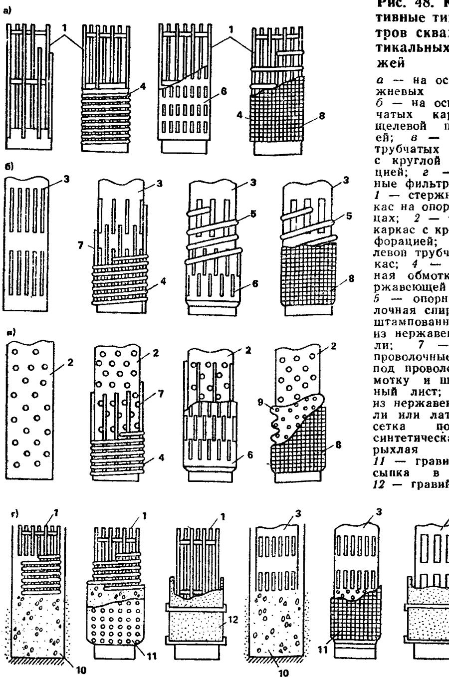
**a** — на основе стержневых каркасов;
