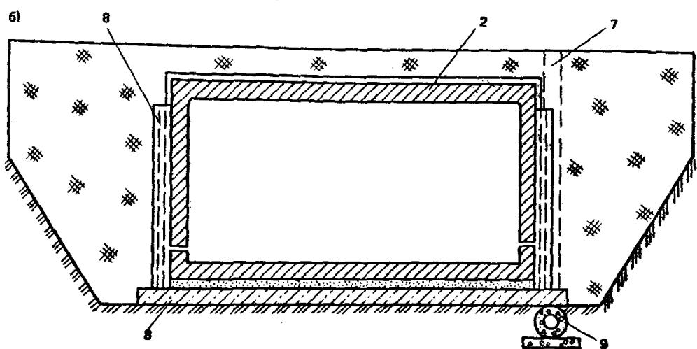
**3.21.** Сопутствующие дренажи (рис. 28, а, б) представляют разновидность пластовых дренажей ленточного типа и устраиваются для предотвращения подтопления коммуникаций, каналов, галерей, оснований проездов и др. Такие дренажи могут иметь значительную протяженность при небольшой ширине.
