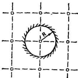
Рис. 116. Систематический вертикальный дренаж
