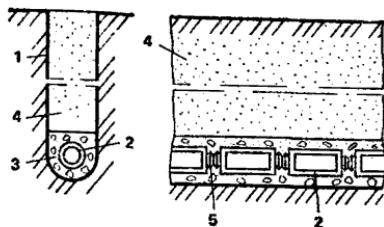
Рис. 41. Конструкция дрены с применением гибких соединительных муфт
