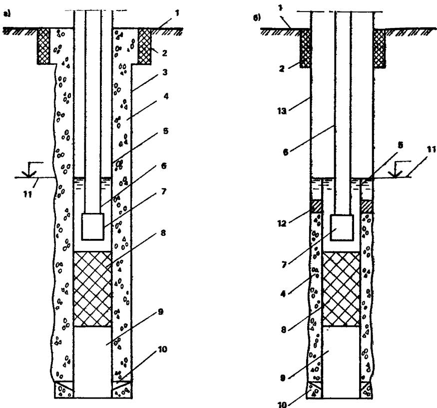
**Рис. 46. Схемы конструкций скважин вертикального дренажа**
