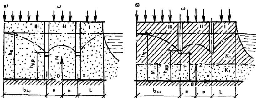
Рис. 75. Расчетные схемы двухлинейного берегового дренажа
