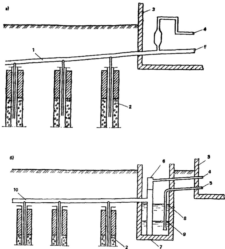
**Рис. 52. Схема вертикального дренажа с вакуумным водоподъемом**
