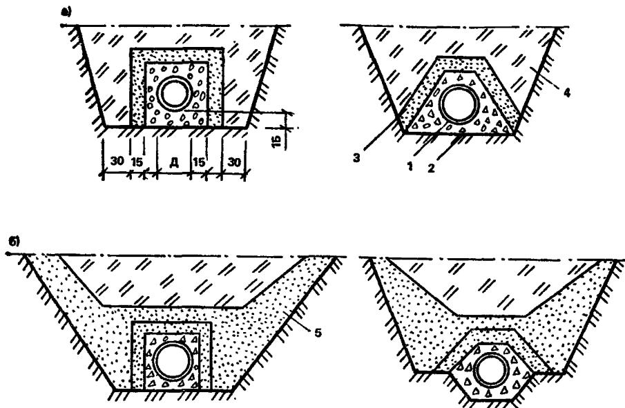
Рис. 37. Конструктивные схемы горизонтальных трубчатых дренажей, укладываемых в траншее
