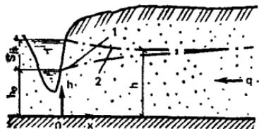
Рис. 18. Подпор грунтовых вод в полубесконечном массиве
