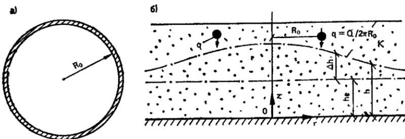
Рис. 16. Поступление дополнительной инфильтрации в пределах кольцевой зоны
