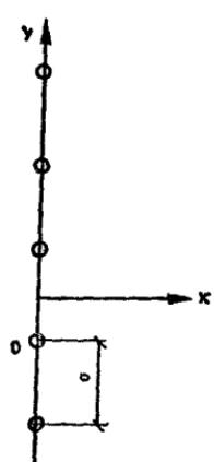
Рис. 113. Линейный ряд скважин в неограниченном пласте
