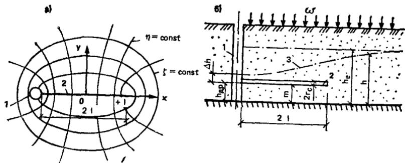
Рис. 94. Схема однолучевого дренажа
