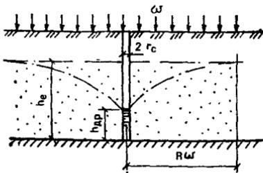
Для определения притоков воды в скважины  $Q_i$  составляется система из  $N$  уравнений вида
