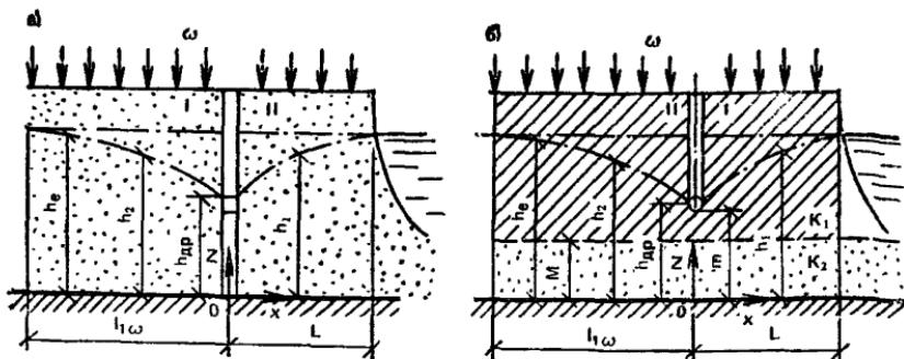
Рис. 74. Расчетные схемы однолинейного берегового дренажа
