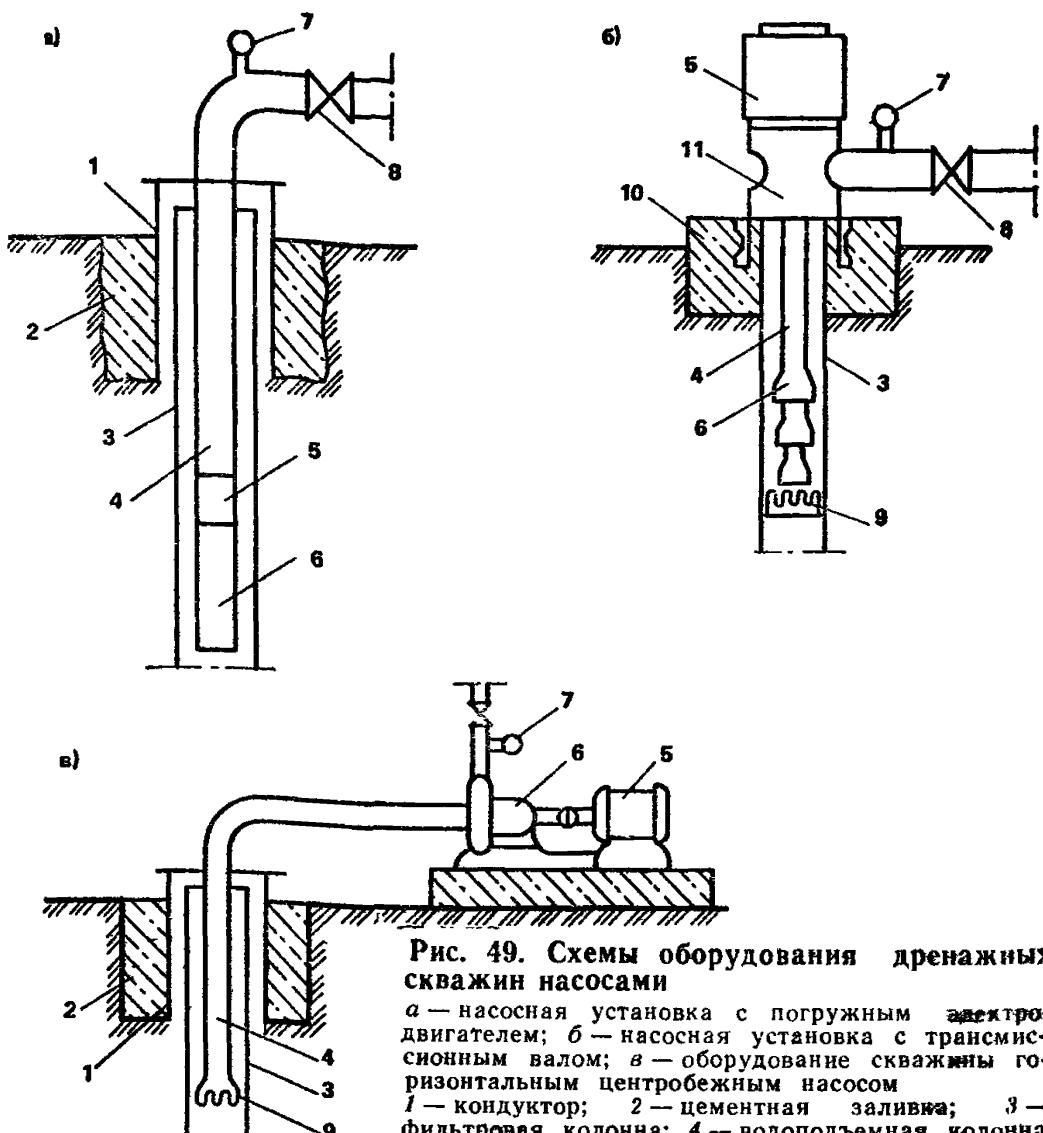
Рис. 49. Схемы оборудования дренажных скважин насосами
