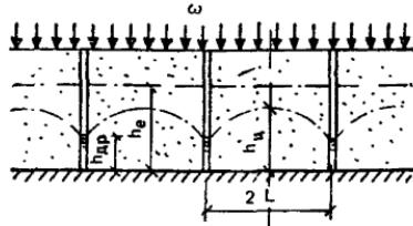
Рис. 64. Схема совершененного систематического дренажа
