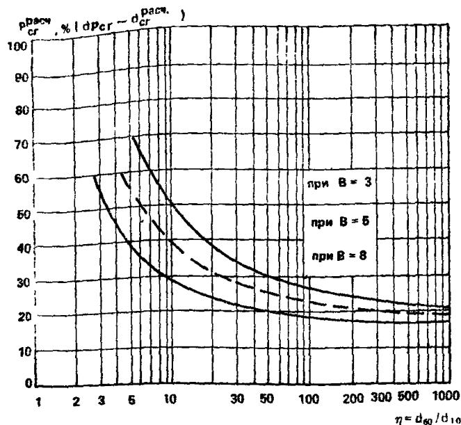
Рис. 124. График  $P_{cr}^{расч} = f(\eta_r)$  для определения расчетных размеров сводообразующих частиц грунта  $d_{cr}$
