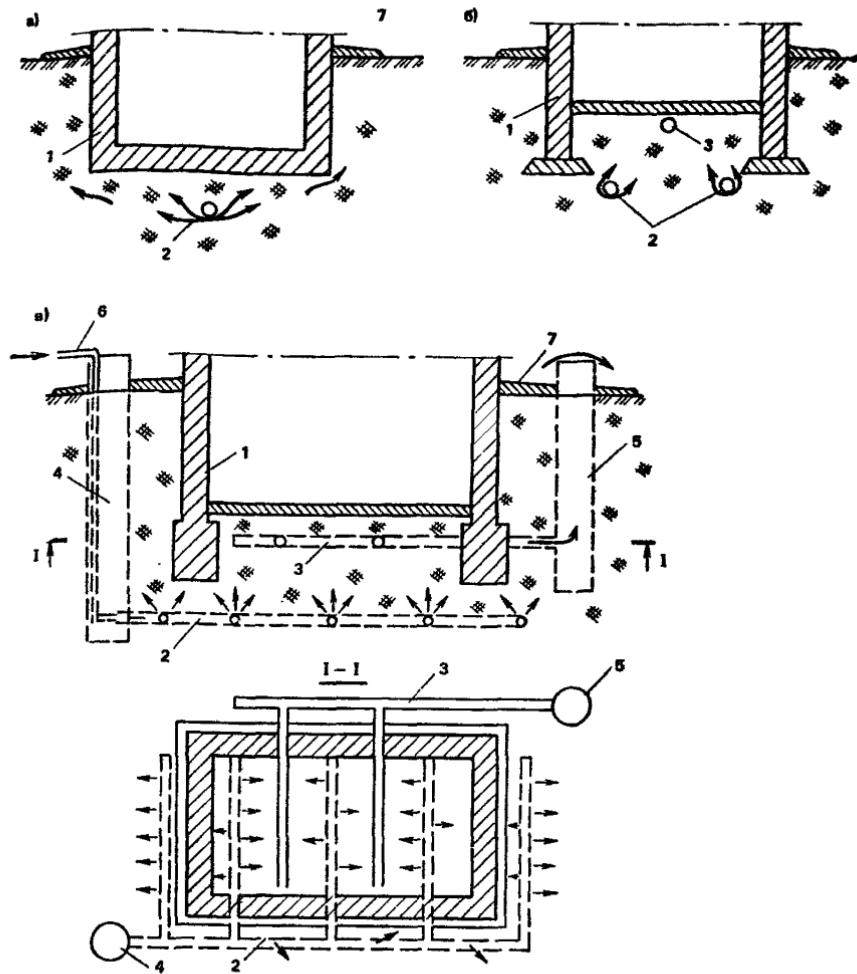
Рис. 54. Конструктивные схемы пневмонагнетательных горизонтальных дренажей
