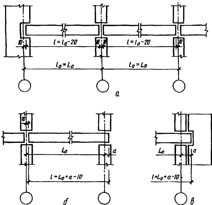
$l_0$  — координационная длина плиты;  $l$  — конструктивная длина плиты;  $L_0$  — расстояние между поперечными координационными осями здания;  $a$  — привязка боковой грани плиты к координационной оси
