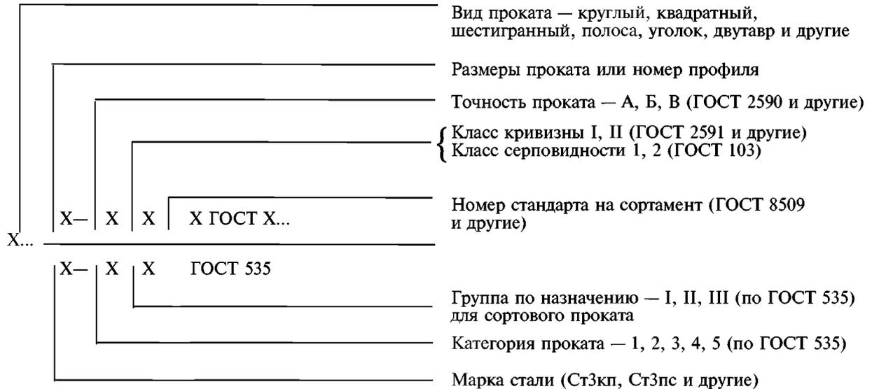
Прокат горячекатаный круглый диаметром 30 мм обычной точности прокатки (В), II класса кривизны, по ГОСТ 2590 марки Ст5пс, категории I, группы II:
