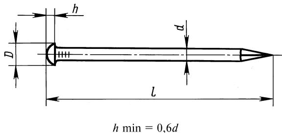
Условное обозначение отделочных гвоздей с диаметром стержня 1,2 мм и длиной 20 мм:
