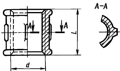
П р и м е ч а н и е. Чертеж не определяет конструкцию муфты.
