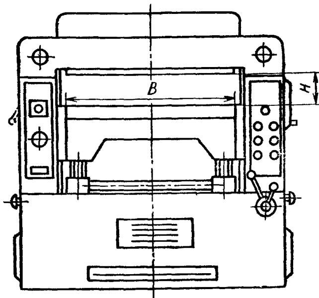
*B* — наибольшая ширина обрабатываемой заготовки.
