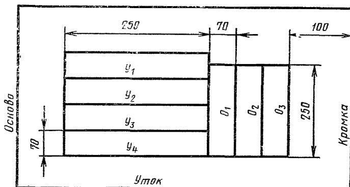
$y_1, y_2, y_3, y_4$  — заготовки уточных пробных полосок;  $O_1, O_2, O_3$  — заготовки основных пробных полосок
