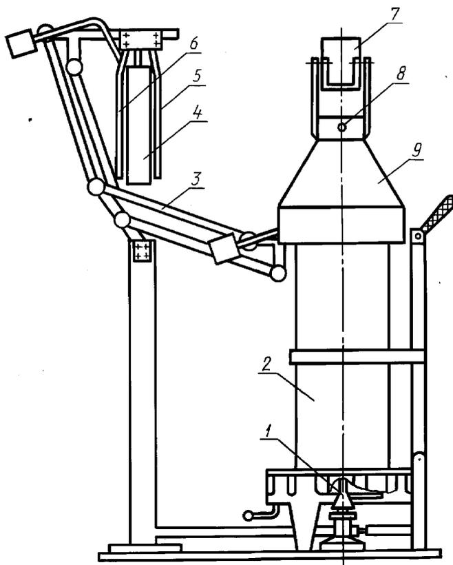
1 — горелка; 2 — реакционная камера; 3 — механизм ввода образца;
