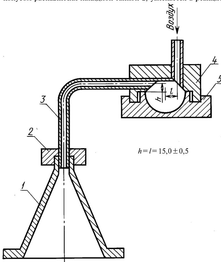
*1* — конус; *2* — гайка накидная; *3* — патрубок; *4* — корпус форкамеры; *5* — доньшко
