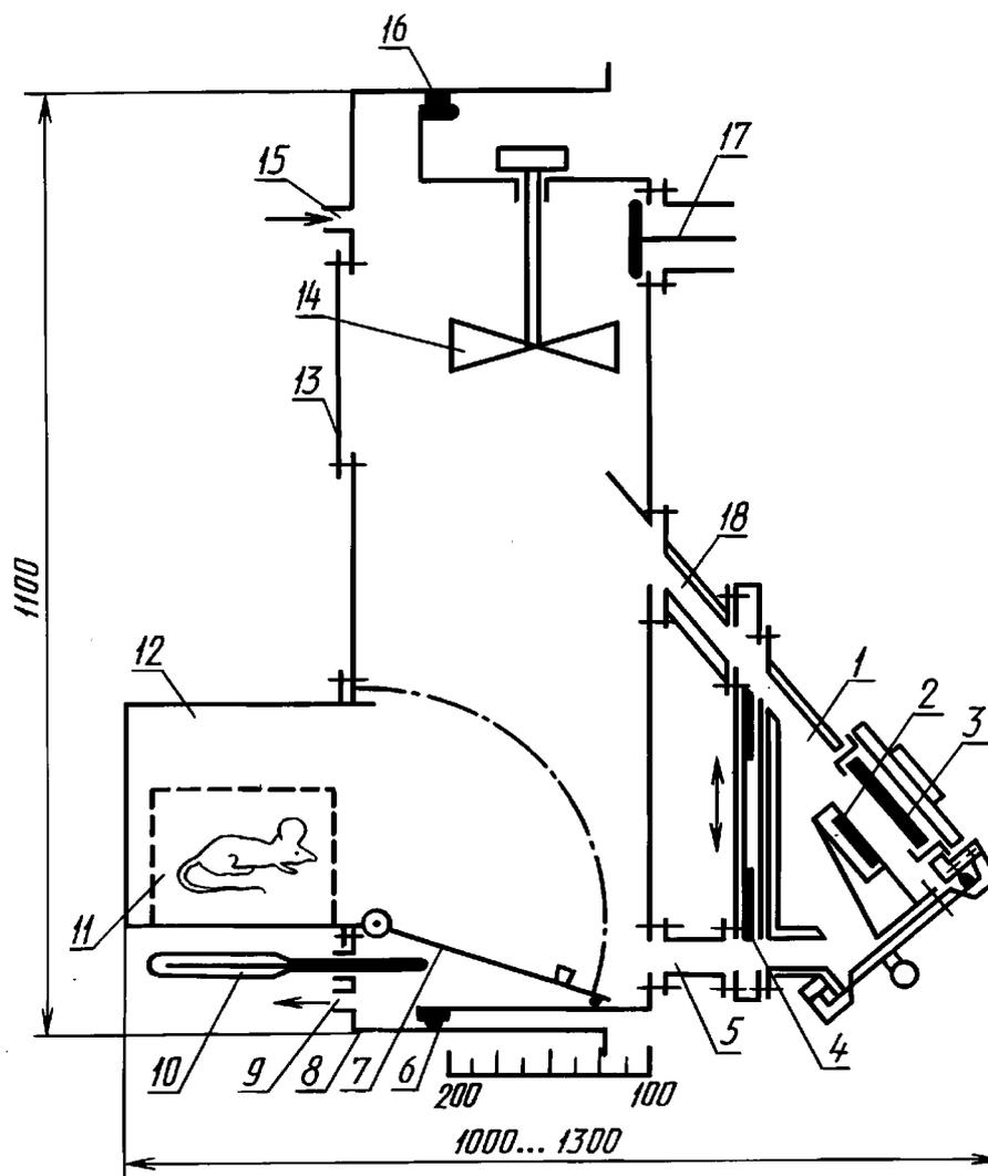
1 — камера сгорания; 2 — держатель образца; 3 — электронагревательный излучатель; 4 — заслонки; 5, 18 — переходные рукава; 6 — стационарная секция экспозиционной камеры; 7 — дверца предкамеры; 8 — подвижная секция экспозиционной камеры; 9, 15 — штуцеры; 10 — термометр; 11 — клетка для подопытных животных; 12 — предкамера; 13 — предохранительная мембрана; 14 — вентилятор; 16 — резиновая прокладка; 17 — клапан продувки
