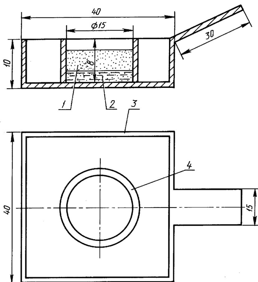
1 — песок; 2 — жидкость; 3 — лодочка; 4 — цилиндрическая емкость
