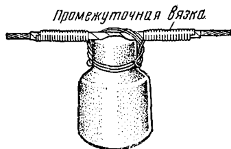
6.73. Крепление сталеалюминиевого провода к изолятору на промежуточных опорах с применением фольги
