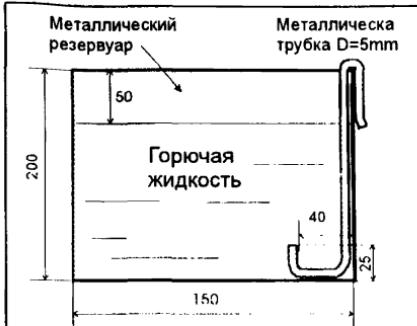
Рис. 2. Основные размеры металлического резервуара для огневых лабораторных испытаний низкократной пены подслойным способом
