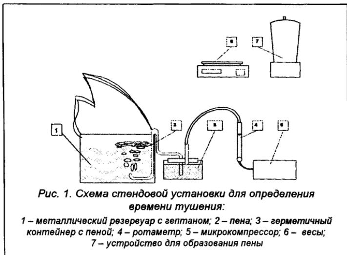
Рис. 1. Схема стеновой установки для определения времени тушения:
