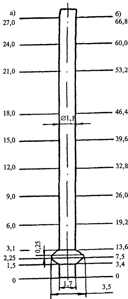
Схема зависимости объема уложенной бетонной смеси от уровня ее в скважине:
