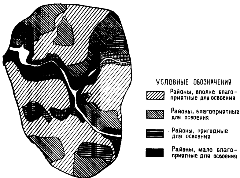
Рис. 1. Схематическая карта инженерно-гидрологического районирования территории города для организации подземного пространства
