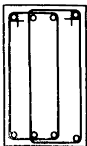
Рис. 113. Конструкция хомутов вязаных каркасов балок
