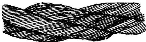
Рис. 1. Обрывы и смещения проволок каната крестовой свивки
