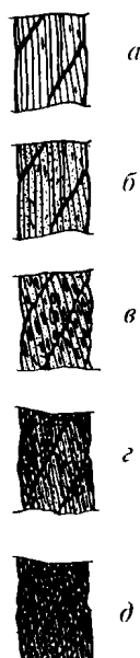
Рис. 5. Поверхностная коррозия проволок каната крестовой свивки:
