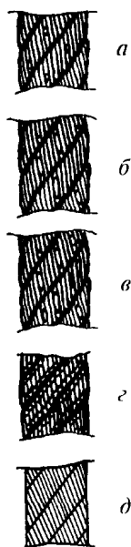
Рис. 4. Износ наружных проволок каната крестовой свивки:
