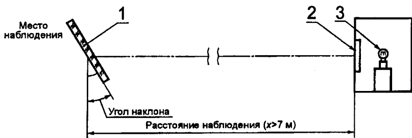
1 — безопасное стекло; 2 — мишень; 3 — соответствующий источник света
