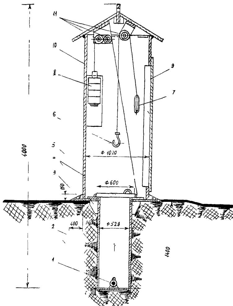
Рис.2. Типовая схема временного хранилища для источников излучения из металлических трубо (размеры даны в мм):
