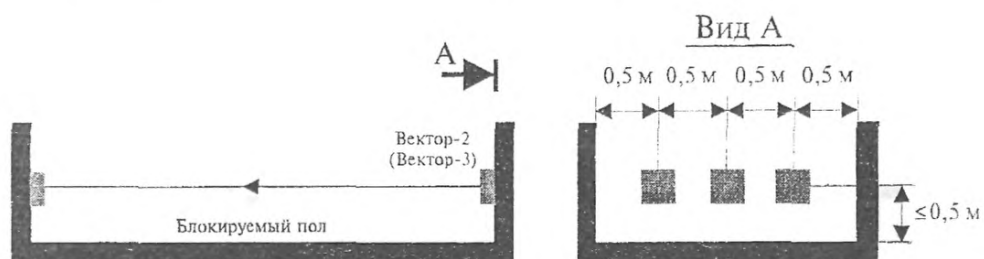
Рисунок 6.27 - Блокировка стен, потолка и пола на проникновение извещателями активными линейными оптико-электронными
