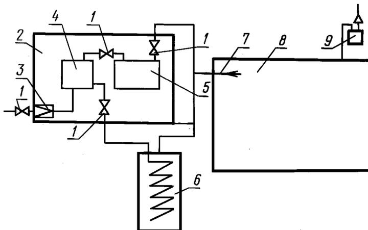
1 — двухходовой вентиль; 2 — камера испарителя; 3 — редуктор; 4 — ресивер; 5 — емкость испарителя; 6 — увлажнитель воздуха; 7 — форсунка; 8 — испытательная камера; 9 — электровентильатор
