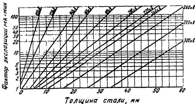
Рис. II. Номограмма для определения времени экспозиции при просвечивании стали рентгеновскими аппаратами непрерывного действия на пленку типа РТ-СШ (чувствительность 25 I/P) при фокусном расстоянии 700 мм и при различных напряжениях на трубке рентгеновского аппарата
