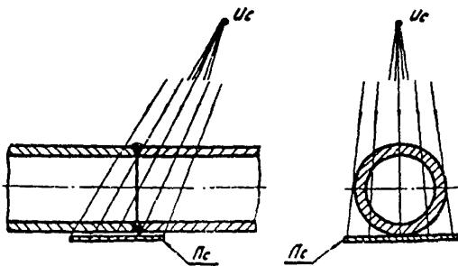
Рис.4. Схема фронтального просвечивания через две стенки за одну или две установки источника излучения на плоскую касету (схема просвечивания "на эллипс")
