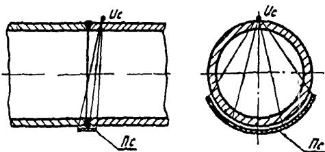
Рис.3. Схема фронтального просвечивания через две стеки за три установки источника излучения
