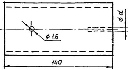
Рис.13. Стандартный образец предприятия для настройки ультразвуковых дефектоскопов:
