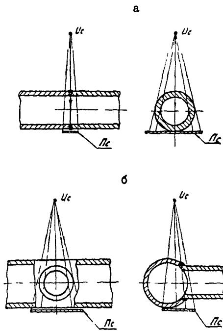
Рис.5. Схема фронтального просвечивания через две стекки за одну установку источника излучения без его смещения относительно сварного шва:
