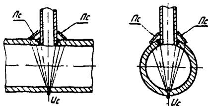
Рис.8. Схема фронтального просвечивания криволинейных швов врезок малого диаметра за одну установку источника излучения
