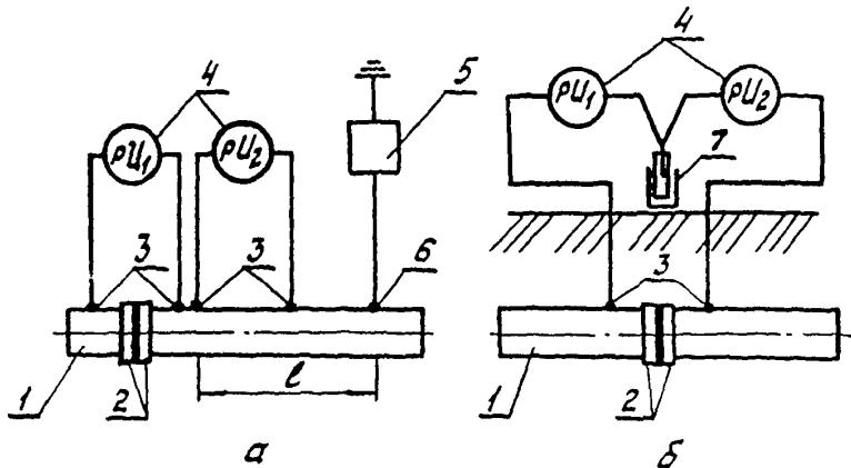
Рис. I.14. Схемы включения измерительных приборов и устройств при опробовании и наладке изолирующих фланцев трубопровода:
