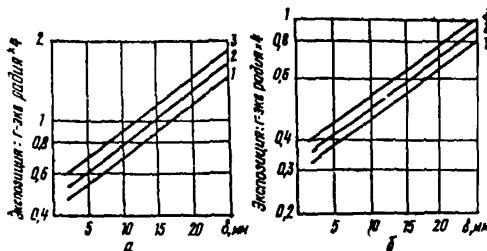
Рис.I2. Номограммы для определения экспозиции при просвечивании стали на рулонную радиографическую пленку РТ-СШ гамма-источниками:
