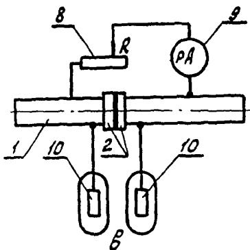
одной из сторон фланцевого соединения. На исправных фланцах синхронный замер показывает "скачок" потенциала;
