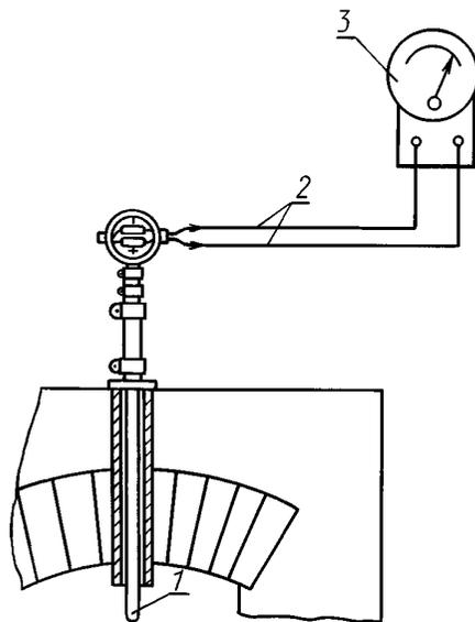
1 — термопара в защитном кожухе; 2 — соединительные провода; 3 — измерительный прибор
