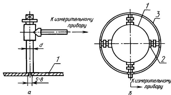
1 — стенка газохода; 2 — патрубок; 3 — соединительный трубопровод
