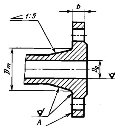
Причание. Допускается обработка поверхностей A с шероховатостью  $R_a \leq 100$  мкм.
