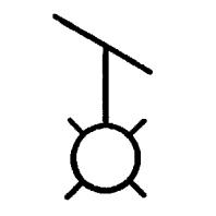
8. Космическая радиостанция на летающих объектах с одновременным приемом и передачей на две антенны
