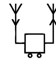
13. Передвижная нерельсовая радиостанция с одновременным приемом и передачей на двух антенных
