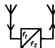
16. Радиорелейная станция с приемом и передачей на разных частотах
