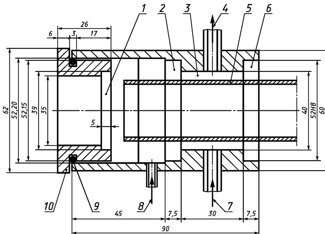
1 — цветное стекло, установленное на эпоксидной смоле; 2 — уплотнительная резиновая прокладка; 3 — водяная камера; 4 — отвод воды; 5 — трубка сжигания; 6 — уплотнительная резиновая прокладка; 7 — подача воды; 8 — подача кислорода; 9 — торсидальная прокладка; 10 — втулка с насечкой
