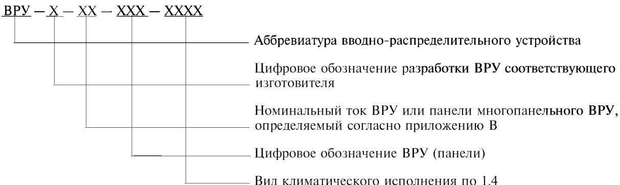
**Примеры обозначений типов панелей многопанельного ВРУ**
