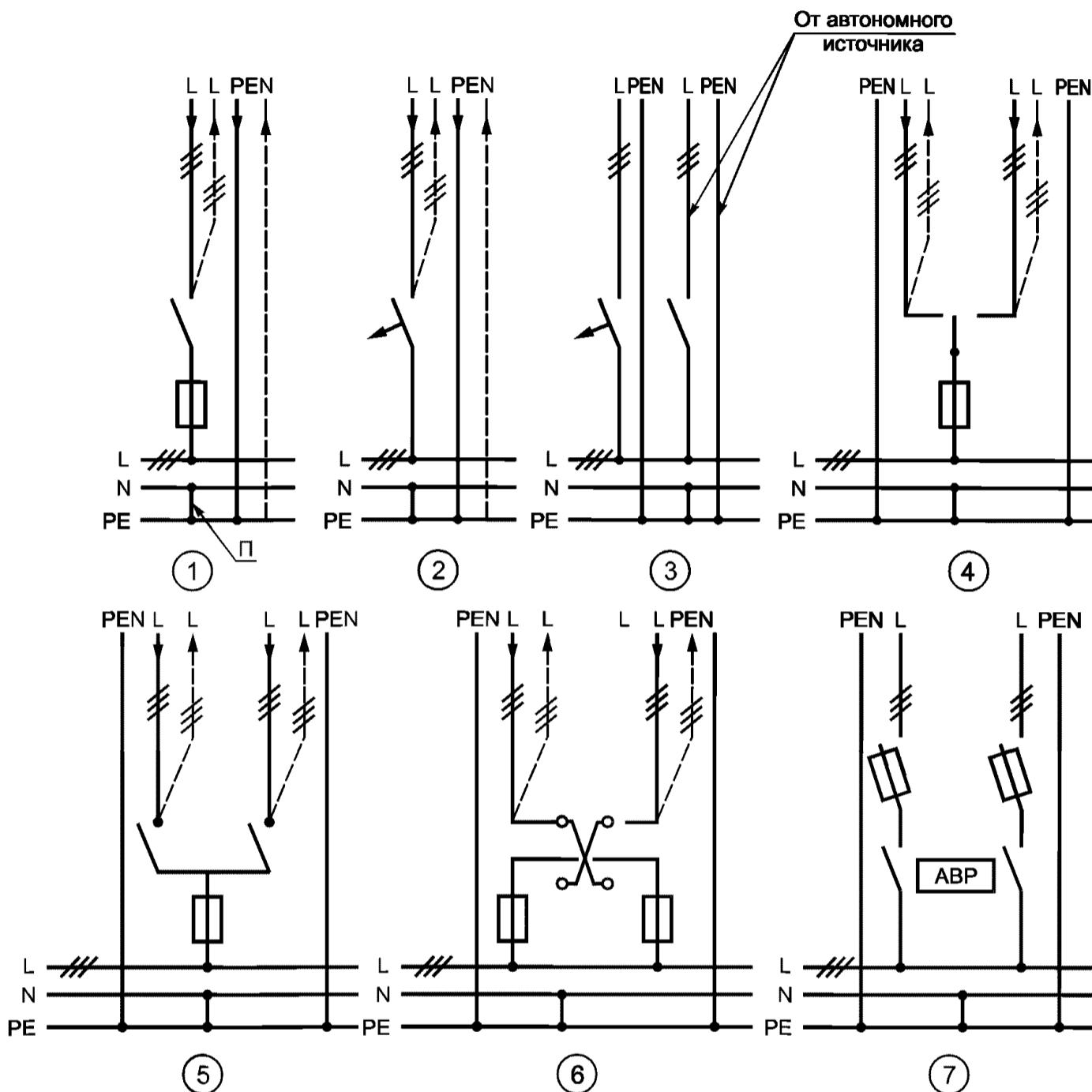
L — фазные проводники; N — нулевой рабочий проводник; PE — нулевой защитный проводник; PEN — совмещенный нулевой рабочий и защитный проводник; Π — перемычка по 6.3.15
