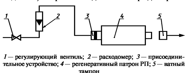
Рисунок 2 — Схема установки для определения наличия пыли регенеративного продукта
