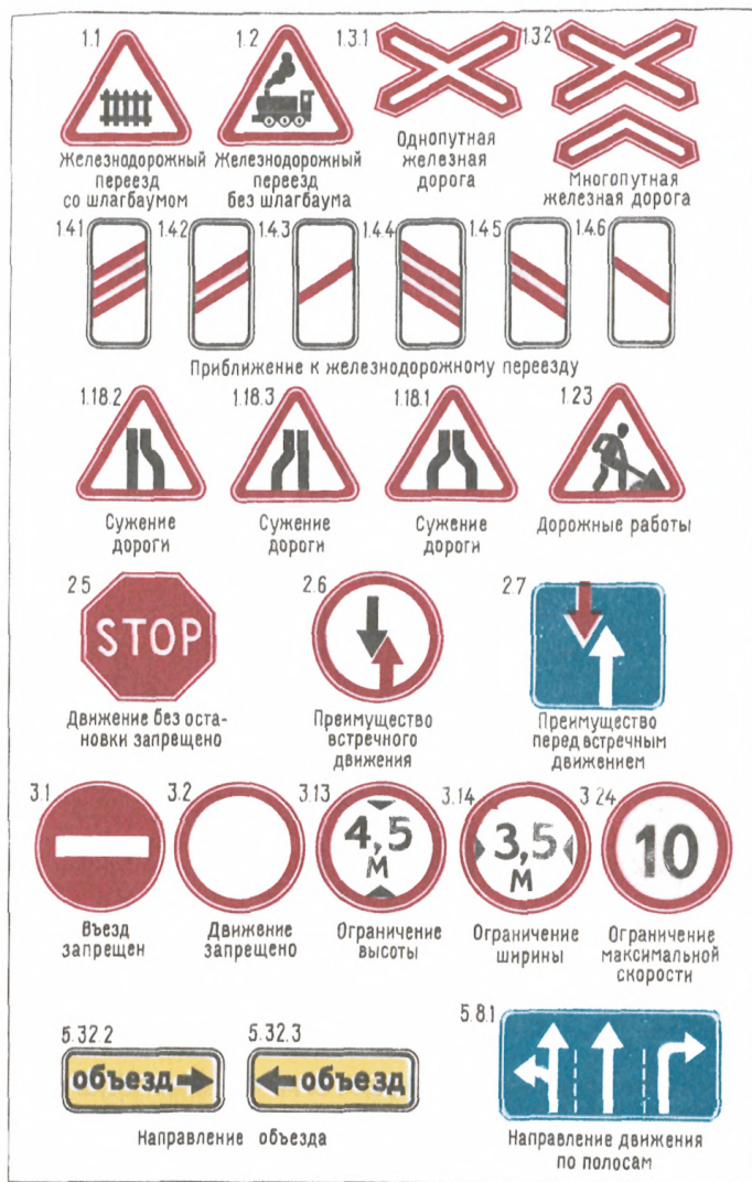
Рис. 1. Дорожные знаки и таблички, устанавливаемые на под- ходах к переездам, местах прогона скота и искусственным сооружениям (ГОСТ 10807—78 "Знаки дорожные")
