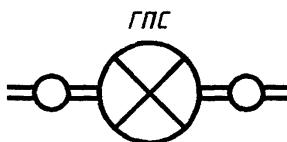
— газопровод с газокомпрессорной станцией
