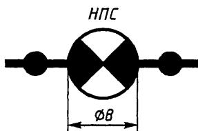
— нефтепровод с перекачивающей станцией
