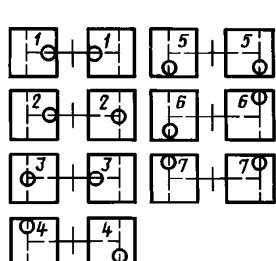
На настольных гирных и циферблатных весах с двумя площадками парные образцовые гири размещают в центре площадок, а затем в положения, указанные на чертеже. Если при каком-либо положении гиры настольные гирные весы не придут в положение равновесия, то при помещении на соответствующую чашку гири-допуска, равной по массе допускаемой погрешности, указатели должны сойтись или перейти положение равновесия.
