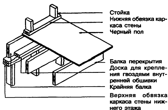
Рисунок 7-4 — Деталь установки доски для крепления внутренней обшивки
