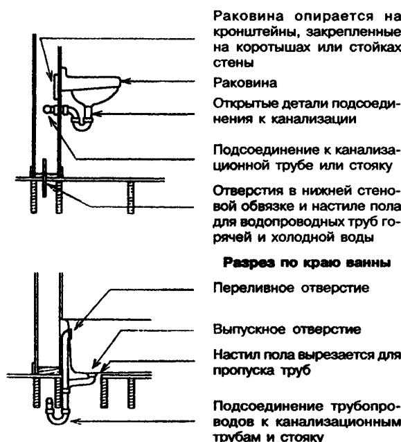
Рисунок 13-6 — Детали установки умывальника и ванны
