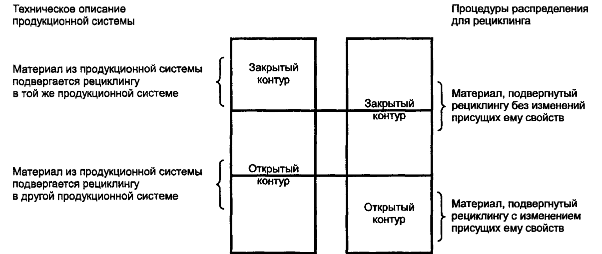
Рисунок 4 — Различие между техническим описанием производственной системы и процедурами распределения для рециклинга
