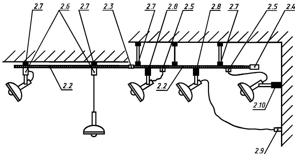
2.2 — секция шинопровода; 2.3 — соединитель; 2.4 — вводное устройство (может включать трансформатор); 2.5 — питатель (питание только от секций шинопровода); 2.6 — адаптер для механического и электрического присоединения светильника к шинопроводу; 2.7 — подвес шинопровода (к потолку, к подвеске из труб или проволоки); 2.8 — подвес светильника; 2.9 — независимая коробка с розеткой; 2.10 — механическое закрепление светильника к стене.
