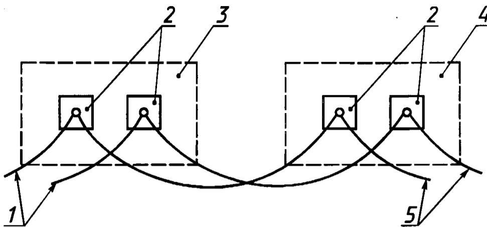
1 — вводы кабелей; 2 — контактные зажимы; 3 — светильник А;
