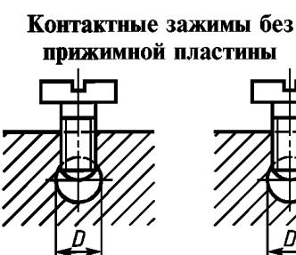
*D* — диаметр гнезда жилы провода
