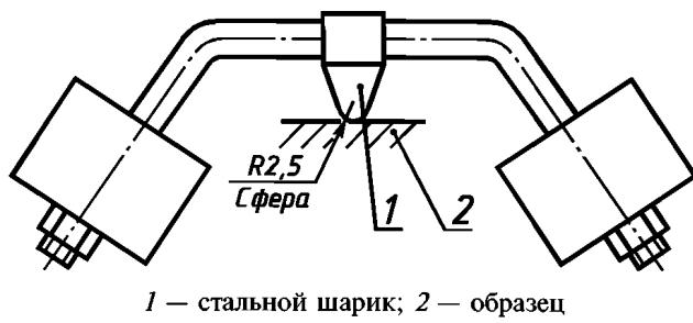
Рисунок 10 — Устройство для вдавливания шарика
