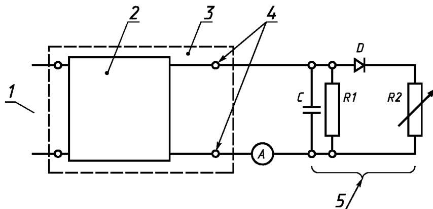
1 — сеть; 2 — ПРА, трансформатор, зажигающее устройство; 3 — светильник;
