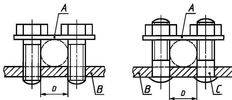
*A* — прижимная пластина; *B* — опорная деталь; *C* — шпилька;
