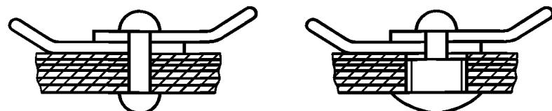
Рисунок 17 — Конструкция неразъемных соединений
