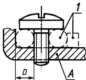
**Винт, требующий шайбу или прижимную пластину**
