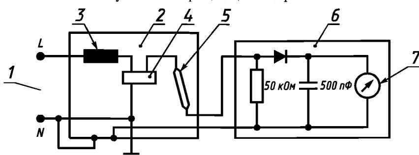
1 — сеть; 2 — светильник; 3 — ПРА; 4 — ИЗУ; 5 — лампа; 6 — измерительное устройство; 7 — высокоомный вольтметр
