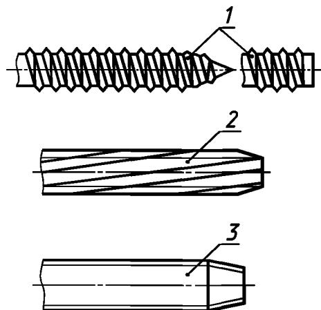
1 — винт саморежущий с острым и плоским концом; 2 — винт резьбонарезающий; 3 — винт резьбоформующий
