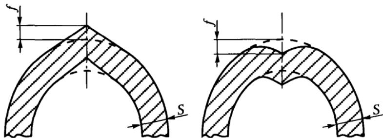
5.5.41. Допускаемые отклонения размеров в выпуклых днищах: отклонения заданной формы выпуклой части, контролируемой шаблонами, — не более 1,25 % внутреннего диаметра днища при внутреннем диаметре более 500 мм и не более 5 мм при внутреннем диаметре 500 мм и менее;
