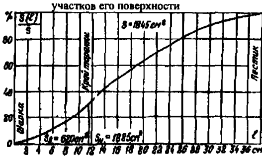
Рис.39. График для определения площади поверхности изолятора ПСГ6-1 (чертеж И-494) и площадей отдельных участков его поверхности
