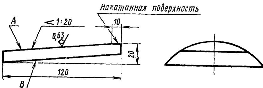
Непараллельность поверхностей *A* и *B* не допускается более 0,05 мм на длине образца.
