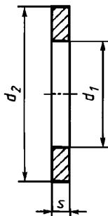
Пример условного обозначения уменьшенной шайбы для крепежной детали с диаметром резьбы 12 мм с толщиной, установленной в стандарте, из стали марки 08kp, с цинковым покрытием толщиной 6 мкм хроматированным:
