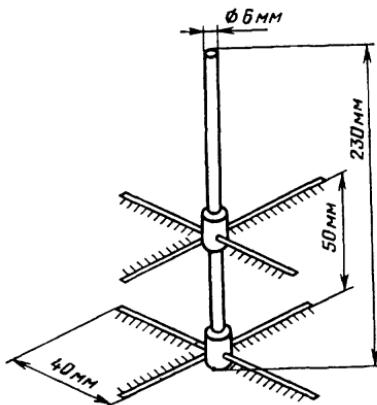
быть ниже уровня воды на 50 мм. По истечении 10 мин рамочку с элементарными пробами вынимают и встряхивают пять раз вдоль элементарной пробы для удаления лишней влаги. Элементарные пробы пинцетом снимают с рамочки, помещают во взвешенные бюксы и взвешивают с погрешностью не более 0,01 г.
