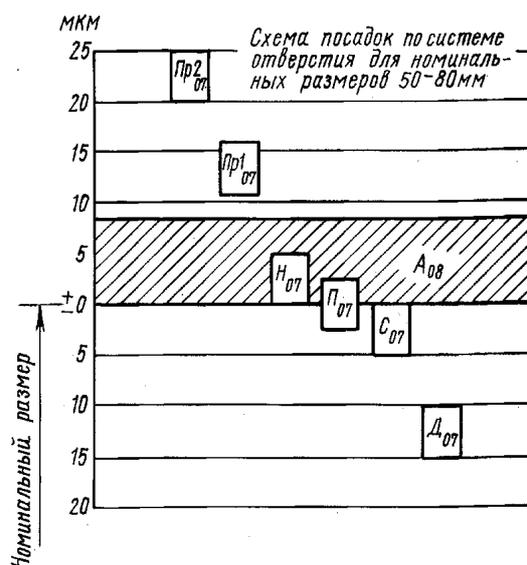
Система отверстия. Валы класса точности 08 в сочетании с основным отверстием класса точности 09
