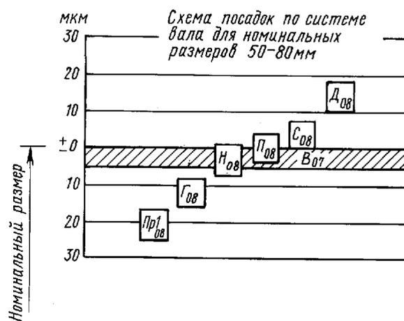
Система вала. Отверстия класса точности 09 в сочетании с основным валом класса точности 08
