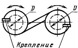
D — диаметр шеек барабанов
