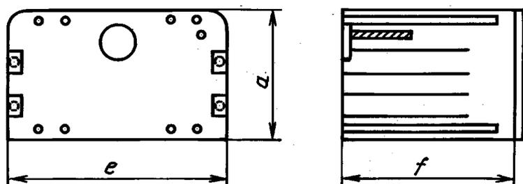
$a$  — высота жарочного электрошкафа, измеренная между внутренними верхней и нижней поверхностями;
