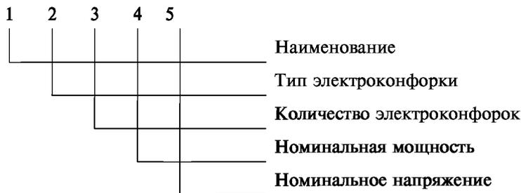
Обозначение электроплиток должно состоять из букв и цифр, означающих: первые три — обозначения буквенные, далее цифровые — номинальная мощность и номинальное напряжение.
