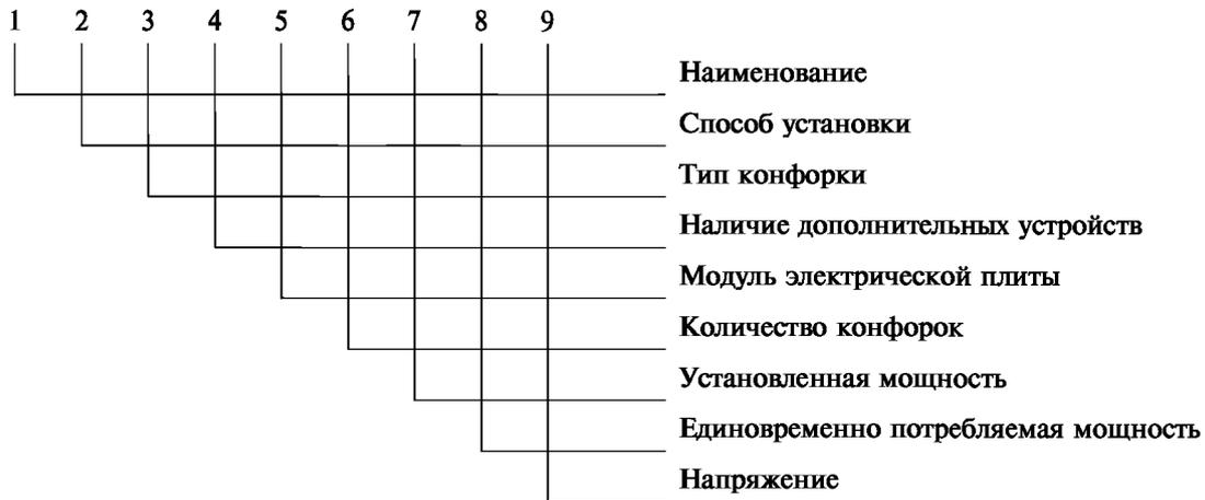
Обозначение электроплит должно состоять из букв и цифр, означающих: первые четыре обозначения — буквенные, далее цифровые — ширина электроплиты(дм), количество конфорок, установленная мощность и (через косую черту) одновременно потребляемая мощность, номинальное напряжение, обозначение настоящего стандарта.
