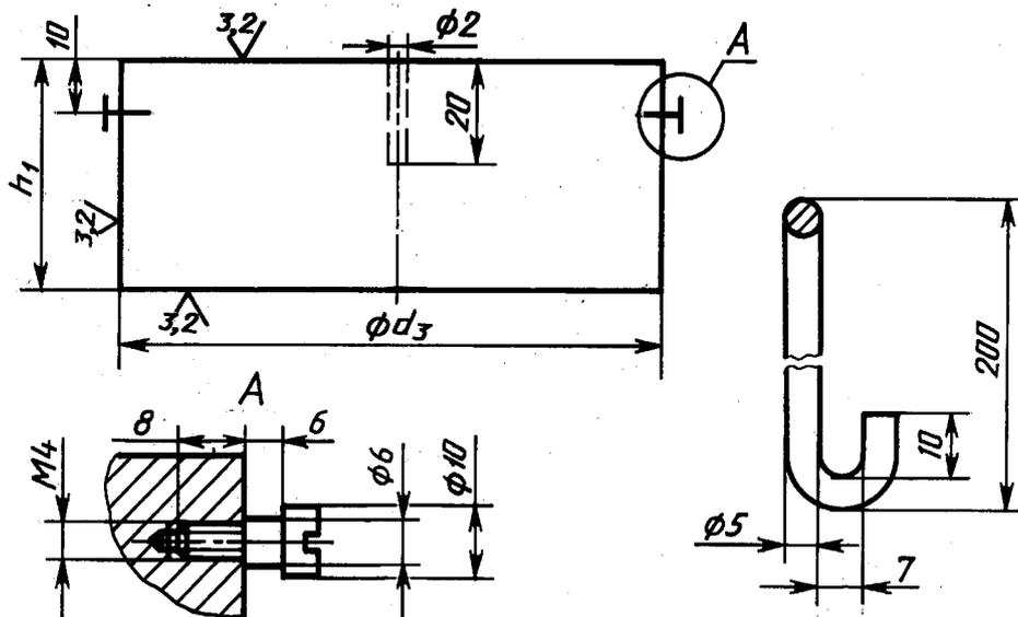
Материал блока — алюминий 92—96 % с удельной теплоемкостью 896 Дж/(кг·К) при 20 °С.
