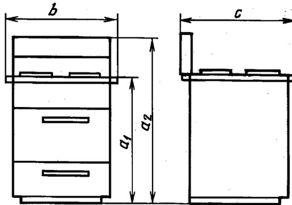
$a_1$  — высота, измеренная между уровнем рабочей поверхности без крышки и полом, на котором установлена электроплита.
