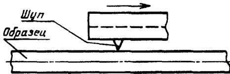
2.2. Контролируемый образец проволоки закрепляется в приспособлении так, чтобы измеряемая поверхность была параллельна плоскости измерения и ходу датчика.
