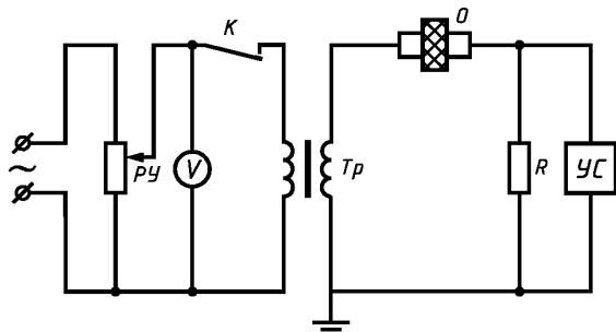
Тр — высоковольтный испытательный трансформатор; R — резистор; РУ — регулятор напряжения; О — образец с электродами; V — вольтметр для измерения напряжения пробоя; ВУ — выпрямительное устройство; С — конденсатор; УС — устройство сигнализации о наступлении пробоя; К — контакт устройства сигнализации, отключающий первичную цепь трансформатора в момент пробоя образца
