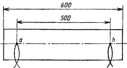
Метки наносят стежками хлопчатобумажных ниток, контрастных по цвету с пробой; концы ниток связывают без стягивания пробы.
