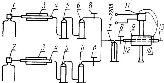
второй абзац. Заменить слова: «электрической трубчатой печи 9 с сопротивлением, разрешающим поддерживать температуру до 1200 °С; термопары платина-платинородиевая 10; гальванометра 11» на «электрической печи 9, позволяющей получать температуру до 1200 °С; системы регулирования с платина-платинородиевой термопарой, обеспечивающей поддержание температур в печи с погрешностью не более указанной в табл. 1»;
